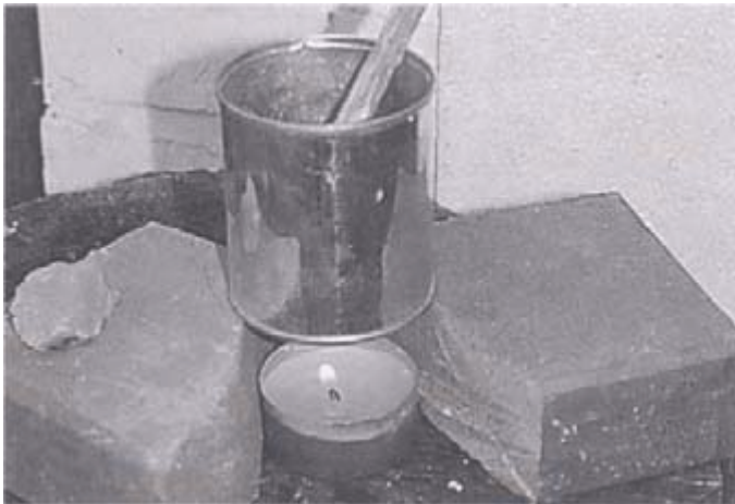
Harz und Wachs werden zu einem Klebstoff zusammen-geschmolzen.
